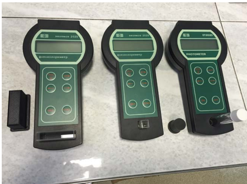
Рис. 1 — Внешний вид фотоколориметров ЭКОТЕСТ-2020 Слева - модификация «ЭКОТЕСТ-2020-МЦ» с кюветой 50 мм, в центре – модификации «ЭКОТЕСТ-2020-1», «ЭКОТЕСТ-2020-4», «ЭКОТЕСТ-2020-8» с квадратной кюветой 10 мм, справа – модификации «ЭКОТЕСТ-2020-ХПК» с круглой кюветой диаметром 16 мм, «ЭКОТЕСТ-2020-8-ХПК» с круглой кюветой диаметром 16 мм, и квадратной кюветой 10 мм.
