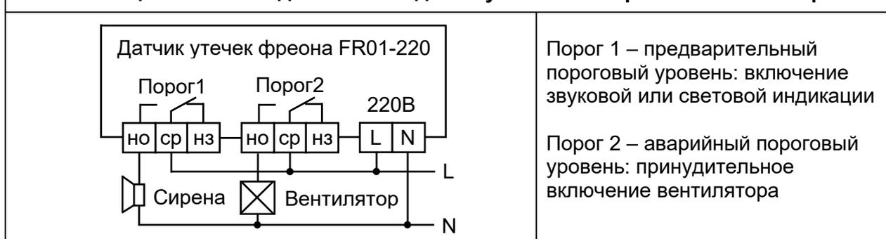
**Таблица 4. Схема подключения к датчику FR01-220 клапана и вентилятора**
