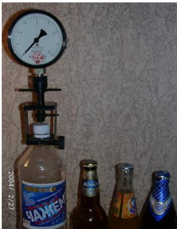
**Афрометр АМ-02** – универсальный прибор с короткой иглой предназначен для измерения давления газа в банках по ГОСТ 23268.2-91, ГОСТ Р 51154-98, ГОСТ 12789-87, ГОСТ 51153-98, ГОСТ 6687.3-87. В приборе установлен манометр на 4 атм. с ценой деления 0,05 атм. кл. 1,5. Манометр поверен. Возможна поставка прибора с манометром 6 атм.
