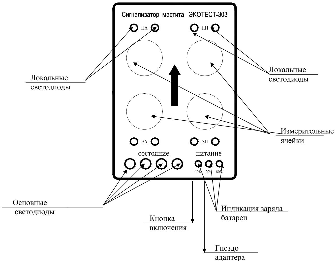
Сигнализатор мастита ЭКОТЕСТ-303 имеет в своем составе следующие составные части:
